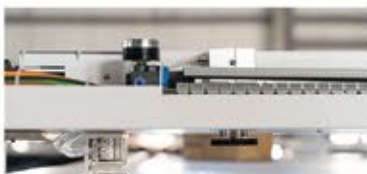
Presión neumática para mayor estabilidad de corte
